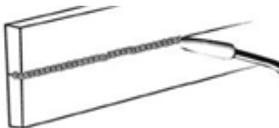
**Рисунок 17. Сварка в горизонтальном положении**
