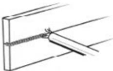
Рисунок 10. Горизонтальное положение при сварке
