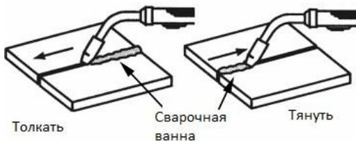
Рисунок 14. Направление движения горелки
